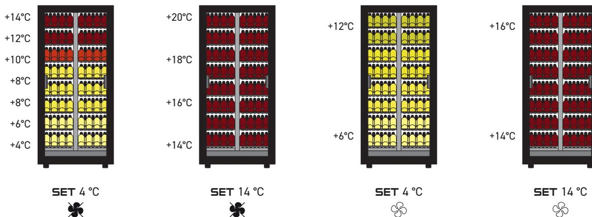
Esempi di alcune possibili impostazioni. L'utente può impostare il SET da +4 °C a +18 °C e selezionare la funzione statica o ventilata direttamente dal termoregolatore. La legenda e le caratteristiche tecniche sono riportate nel Fascicolo commerciale Teca.
